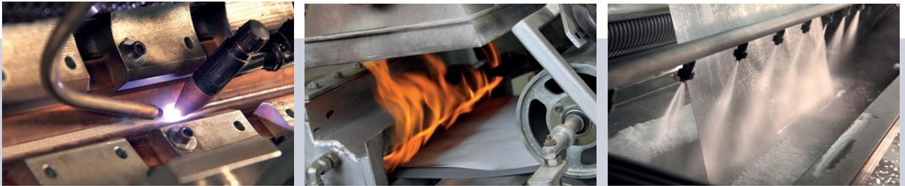
Zu den Produktionsmöglichkeiten bei Haver & Boecker zählen neben der thermischen Behandlung auch das Schweißen und Reinigen komplexer Filterelemente.
