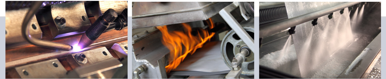
Les possibilités de production chez Haver & Boecker comprennent, outre le traitement thermique, le soudage et le nettoyage d'éléments filtrants complexes.
