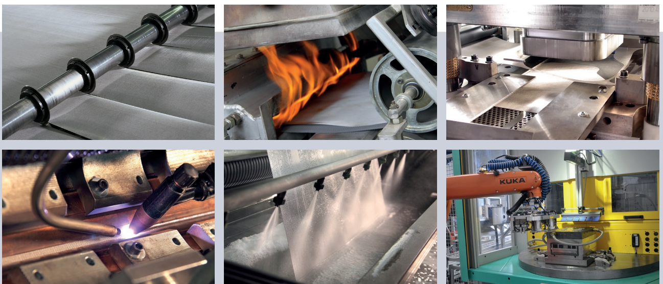
Zu den Produktionsmöglichkeiten bei Haver & Boecker zählen unter anderem: Schneiden · Thermische Behandlung · Stanzen und Formen · Schweißen · Reinigen · Kunststoffumspritzen.
